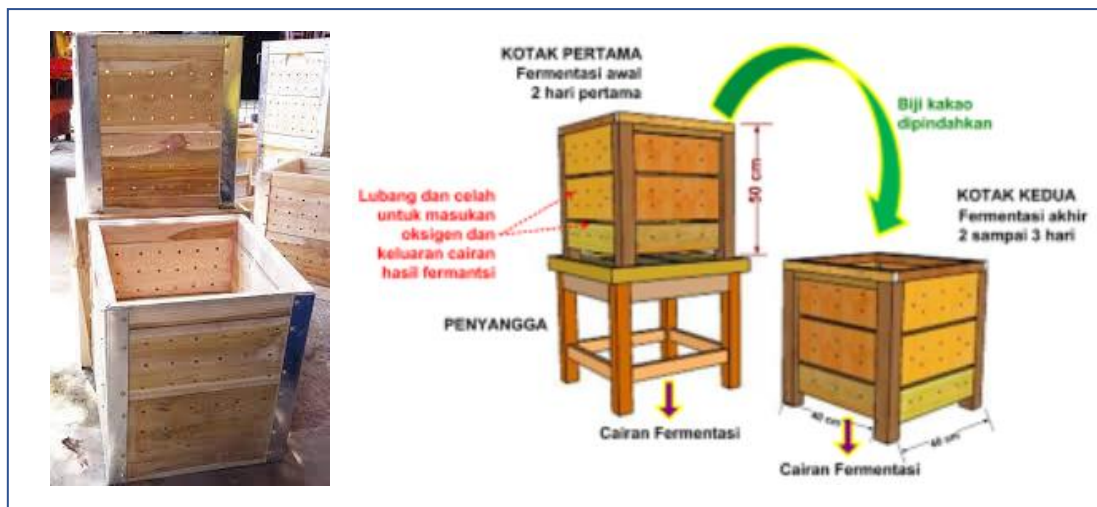
Gambar 2. Kotak Kayu dan Proses Fermentasi
