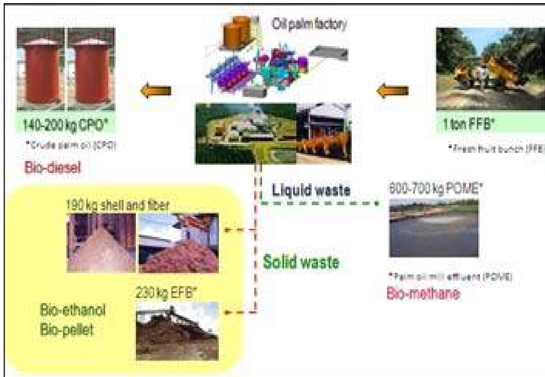
Gambar. 3.14 Mass Balance Dalam Industri Pengolahan Minyak Kelapa Sawit (Kismanto, 2006 dimodifikasi: Aminta et al)
