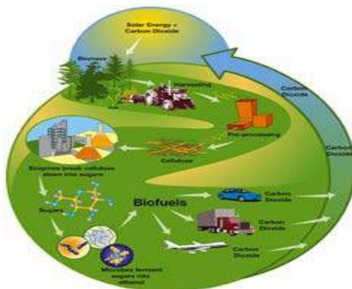
Gambar. 3.13 Siklus Karbon Tertutup Pada Penggunaan Bahan Bakar yang Bersumber dari Biomasa yang Berlignoselulosa
